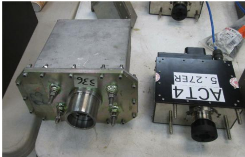
Figura 2. Los actuadores de dos generaciones del sistema activo de control de la superficie del reflector primario. Lado izquierdo - actuadores instalados en los anillos 1, 2, y 3 en 2006, fabricados por la empresa KUN. Estos actuadores, por su tamaño, no pueden ser instalados en los anillos exteriores (4 y 5), y además no cumplen con las especificaciones de precisión del diseño original. Lado derecho - la nueva generación de actuadores, año 2016, fabricados por la empresa ADS International que cumplen exitosamente con todas de las especificaciones de precisión y operación.
