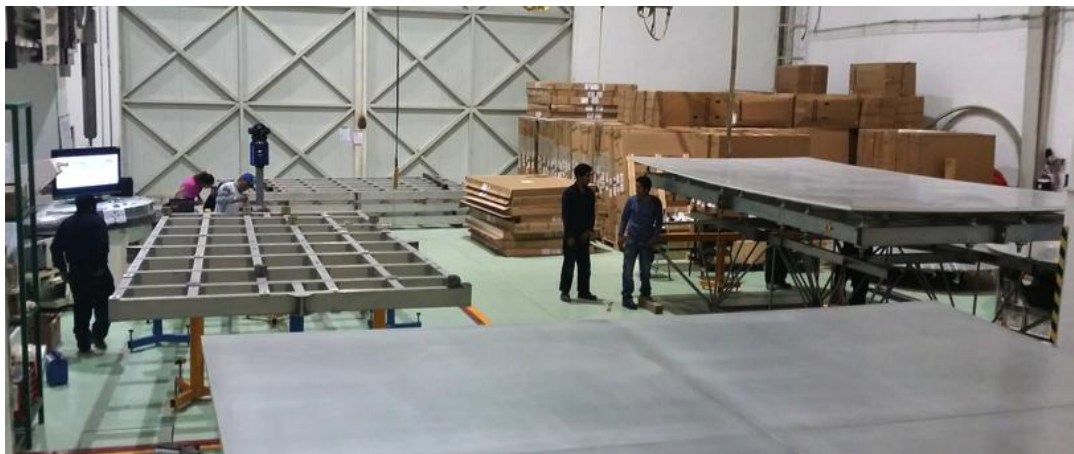
Figura 1. Segmentos de la superficie del reflector primario del anillo 5 en el laboratorio de superficies esféricas del INAOE. Los anillos 4 y 5 de la superficie del reflector primario tienen un total de 96 segmentos. Cada segmento consiste de la integración y alineación de 2500 componentes individuales, con el objetivo de construir un segmento de 5m por 2m de dimensiones con una precisión de la superficie de aproximadamente 20-25 micras r.m.s. En el fondo puede verse una fracción pequeña de las cajas de los 768 sub-paneles de Media Lario para integrar en los segmentos individuales de anillos 4 y 5.
